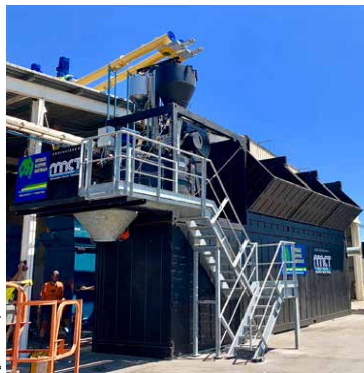
MCM Plant Mixer discharge Austrag des MCM-Anlagenmischers
